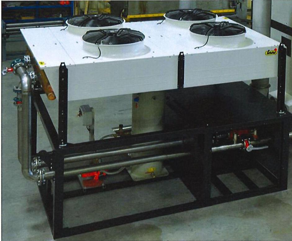
Installation de refroidissement d'eau par ventilation d'air au travers d'une batterie de tubes.
