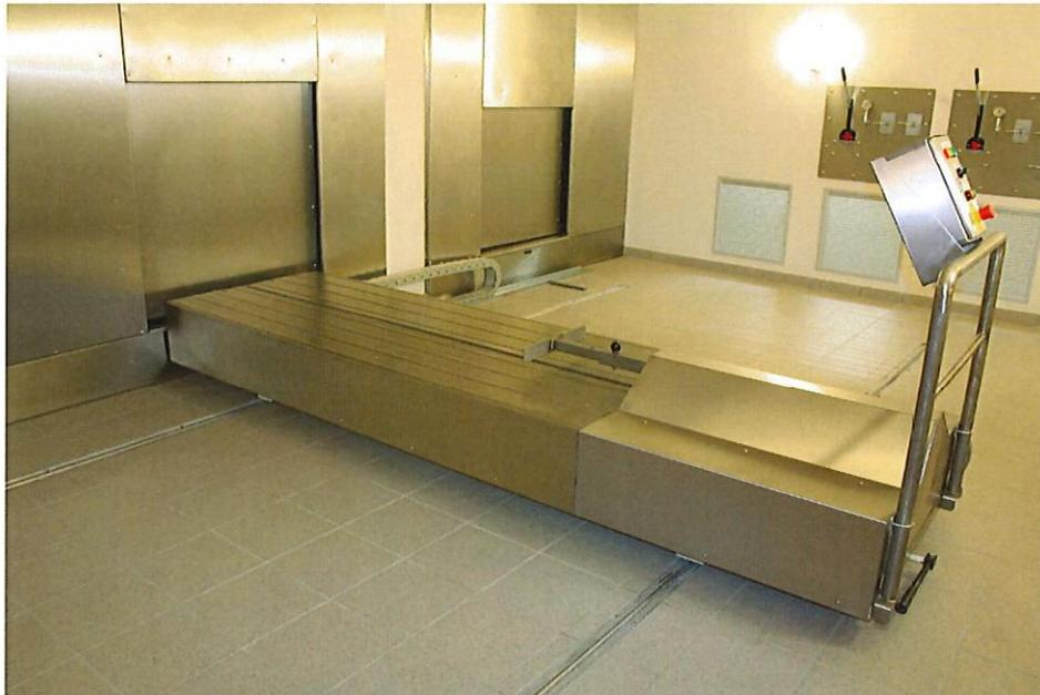
Une tige poussoir, réglable en longueur en fonction de la dimension des cercueils, actionnée par un moto-réducteur avec chaîne de transmission, introduit le cercueil sans à-coups. Ce dispositif permet à un seul opérateur d'effectuer sans difficulté la mise à la flamme du cercueil dans le four. Le système sera soit fixe soit sur rails pour permettre une utilisation aisée du four en accord avec les souhaits de l'utilisateur.
